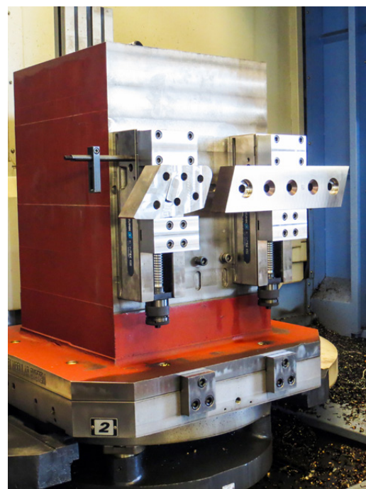
Sopra: fresatura telai per attrezzature dedicate al settore riciclaggio e demolizione.
