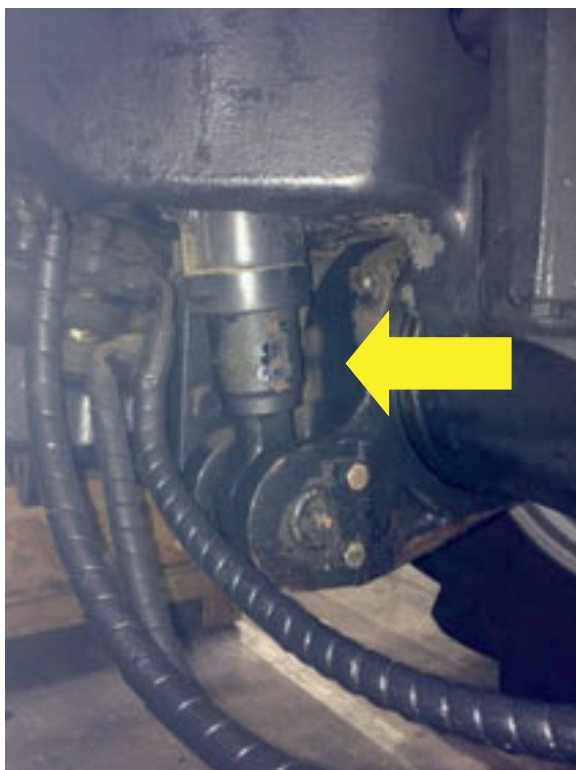
Cilindro idraulico Ognibene 65/55x152 montato sull'assale anteriore (trattori n. 4, 5)
