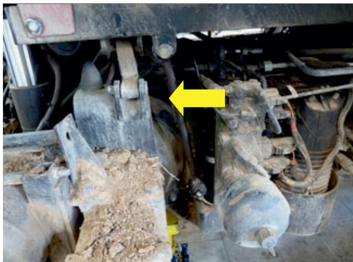
Distanziale rigido (in sostituzione dell'ammortizzatore a molla Monroe Sensatrac) montato sotto la cabina sul lato posteriore (trattore n. 5)
